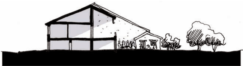
Le projet consiste à réduire la profondeur du bâtiment sur l'arrière, permettant d'ouvrir de larges percements sur le jardin.
